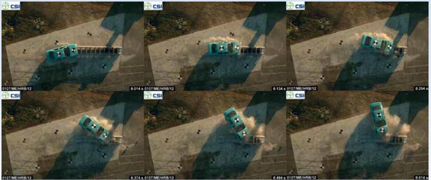
Bild 1: Der Ablauf eines Crashtests nach der Europäischen Norm EN 1317
