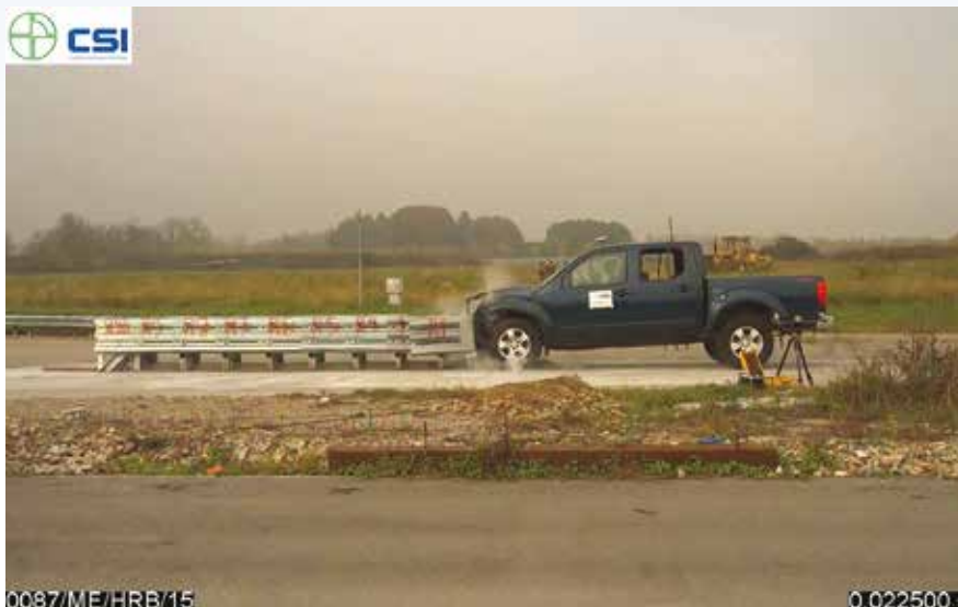
Bild 1: Der Ablauf eines Crashtests nach der Europäischen Norm EN 1317
