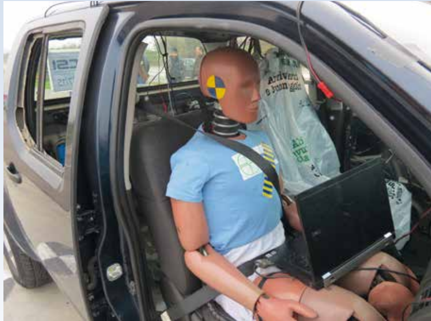
Bild 4: Ein Crashtestfahrzeug, das mit einem EuroNCAP-Dummy ausgestattet ist, der die Messung von Verletzungen ermöglicht, die der Insasse nach einem Unfall erlitten hätte
