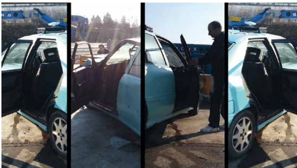
Bild 3: Öffnen der Fahrzeurtüren nach einem Aufprall mit 130 km/h: Dieser Aufprall erzeugt eine kinetische Energie von 820 kJ. Die Rückhaltevorrückung muss die Gefahr einer Verformung des Fahrgastraums verhindern, damit die Türen geöffnet werden können
